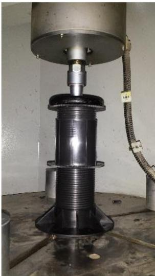
Испытание опоры Level 240-300 в раскрученном виде
