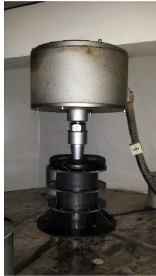
Испытание опоры Level 145-240 в скрученном виде
