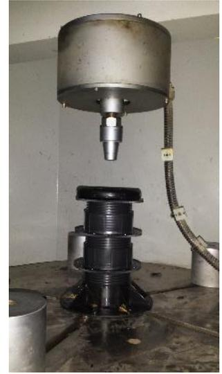
Испытание опоры Level 145-240 в раскрученном виде
