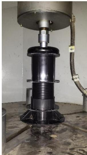
Испытание опоры Level 290-380 в скрученном виде
