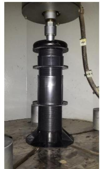
Испытание опоры Level 290-380 в раскрученном виде
